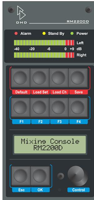
**Abbildung I-9:** Pegelmesser, Setup-Tasten, Funktionstasten, LCD-Anzeige, ESC-, OK-Taste und Drehgeber (von oben nach unten)
