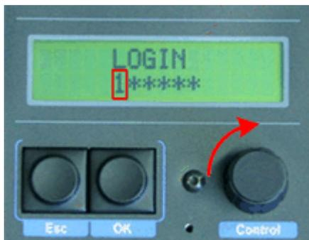
3. Haben Sie die erste Ziffer eingestellt, drücken Sie die Taste "OK". Die Eingabe wird bestätigt und die zweite Ziffer wird aktiviert. Drehen Sie erneut am Encoder-Rad, bis die korrekte Ziffer eingestellt ist.
