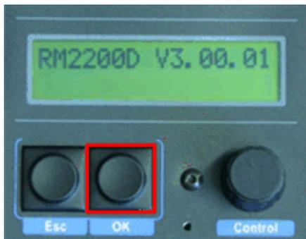
2. Nach 5 Sekunden wechselt die Anzeige auf "Login". In der Zeile darunter ist ein 6-stelliger Code zu sehen, eine Ziffer gefolgt von 5 Sternchen. Drehen Sie am Encoder-Rad, um die erste Ziffer des Passworts einzustellen, dass Sie eingeben wollen.
